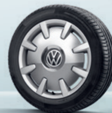
Jante alliage « Disc ». 3) 8 J x 18. Surface brillante couleur argent. Avec pneus 255/45 R 18. | BE | CO | OC |
