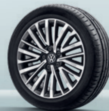
Jante alliage « Palmerston ». 8 J x 18. Avec pneus 255/45 R 18. | BE | CO | OC |
